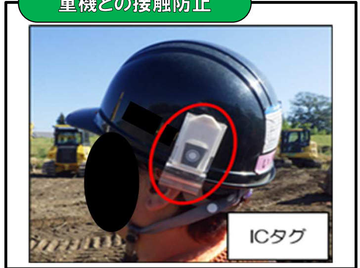
ICタグの活用 (重機に作業員が近づいた場合に、重機オペレーターへ警告)
