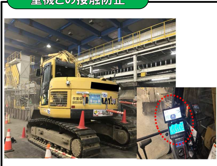
重機の死角を操縦席モニターで確認可能
