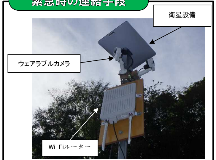
衛星通信設備を設置し、緊急連絡手段を確保 ウェアラブルカメラにより、遠隔で現場の状況把握が可能
