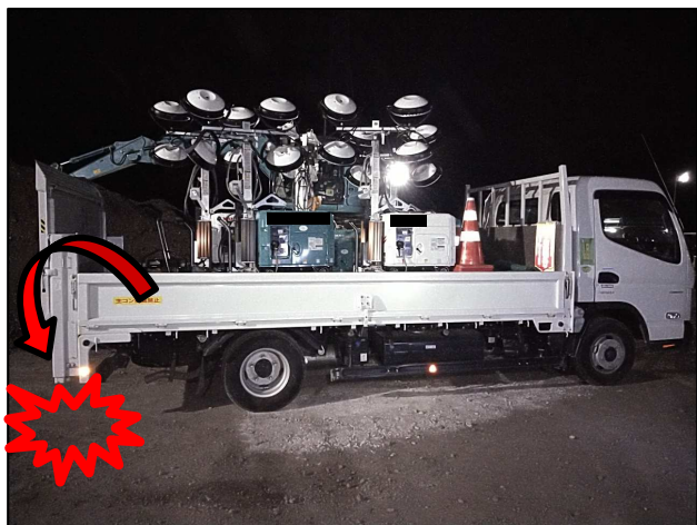
作業車の荷台から建設機材（ランマー）が落下し、後続の一般車が乗り上げ損傷した事案
