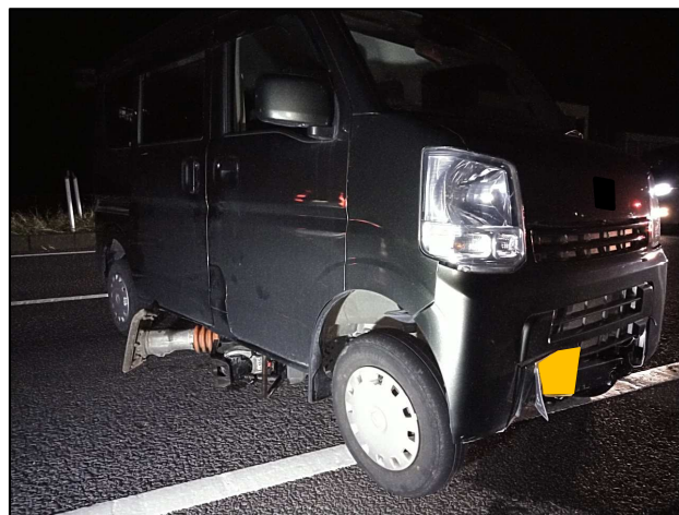
作業車の荷台から建設機材（ランマー）が落下し、後続の一般車が乗り上げ損傷した事案
