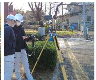
地上型レーザスキャナを用いた起工測量
