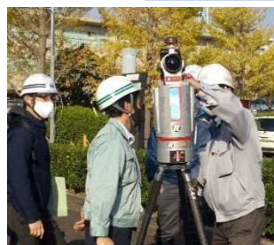
地上型レーザスキャナを用いた起工測量
