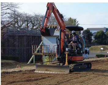
マシンコントロールによる排土板制御
