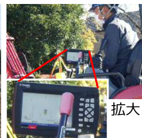
マシンコントロールによる排土板制御
