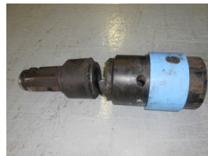
オーガモータ・スクロー接続ジョイント切断状況
