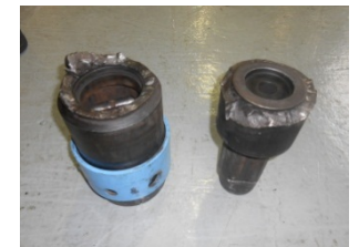
オーガモータ・スクロー接続ジョイント切断状況
