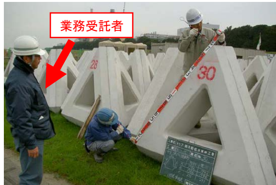
(根固めブロックの材料確認)
