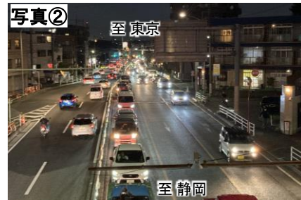
【下り方向】夕方ピーク時に右折車が右折車線をはみ出し直進車を阻害している様子
