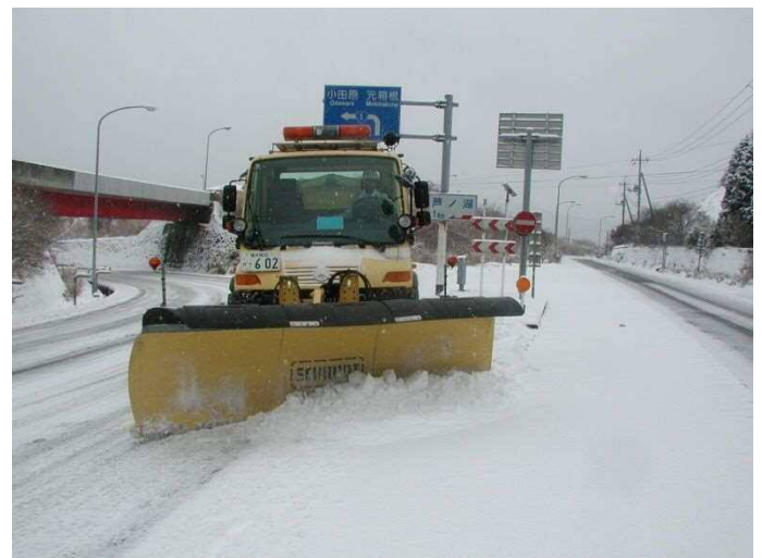
除雪作業 (国道1号箱根新道)
