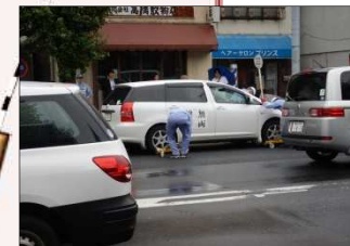
①車両移動用ジャッキによる車両移動
