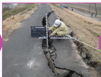
被災箇所の調査を行い、緊急性の有無や対策工法等について検討
