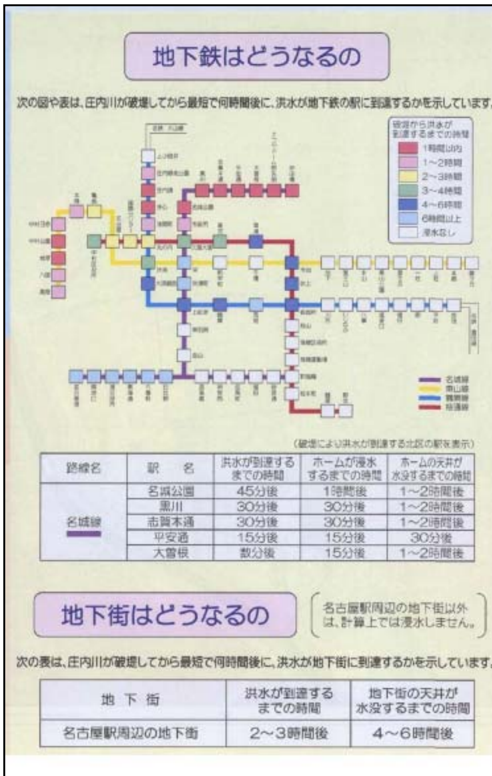
図 24 地下鉄駅へのはん濫水到達時間記載例 (出典：庄内川・新川洪水ハザードマップ 平成14年6月 名古屋市)
