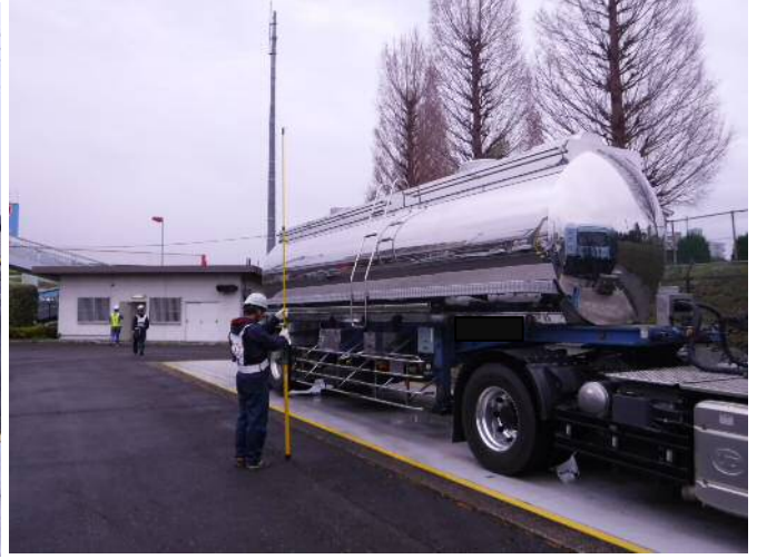
寸法(高さ)計測状況
