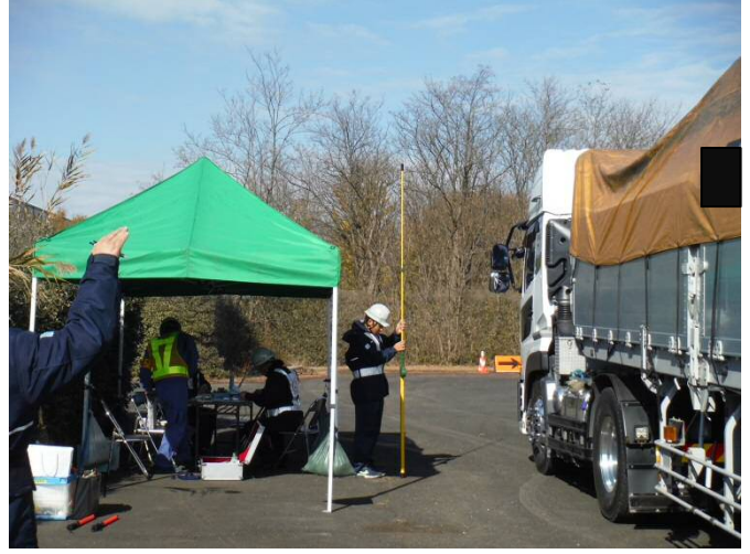
寸法(高さ)計測状況
