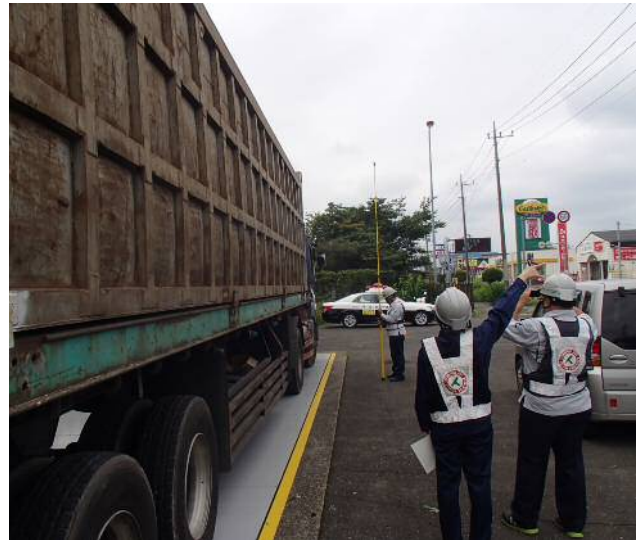
寸法(高さ)計測状況
