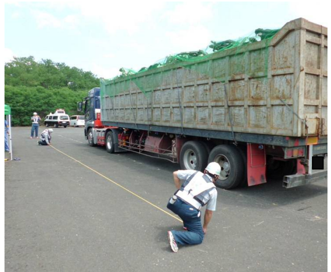
寸法計測状況
