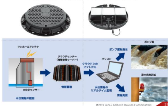
図 2-5 マンホール蓋の進化（ICT 機能）（講演資料より）
