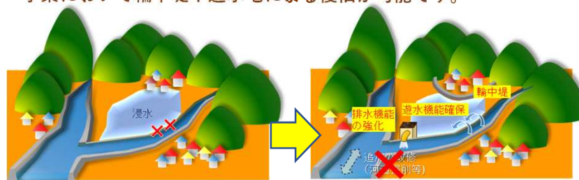
低い堤防が越水・決壊し浸水
