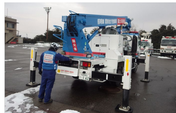
災害対策機械の派遣前点検
