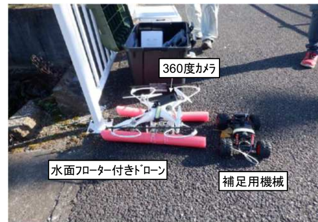
水面フロッター付きドローン本体
