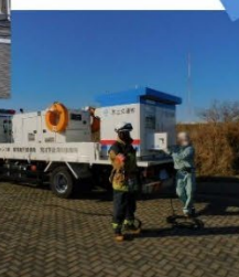
戸田市消防本部・荒川下流排水ポンプ車が戸田緊急用船着場において取水準備
