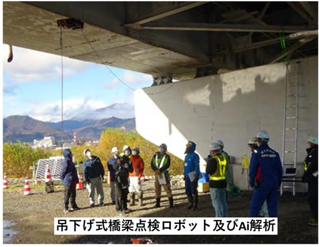
吊下げ式橋梁点検ロボット及びAi解析
