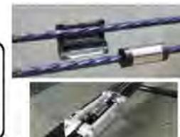
センサーによる橋梁ケーブル張力のモニタリング
