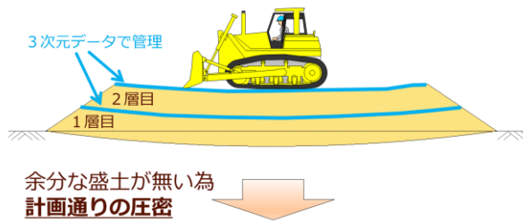
図-4 従来と ICT 活用の転圧状況比較
