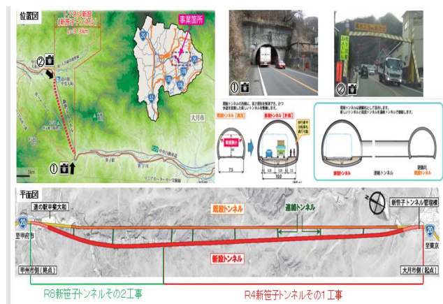
図-2 トンネル工事の施工概要
