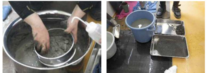
図-6 簡易粒度分布試験実施状況
