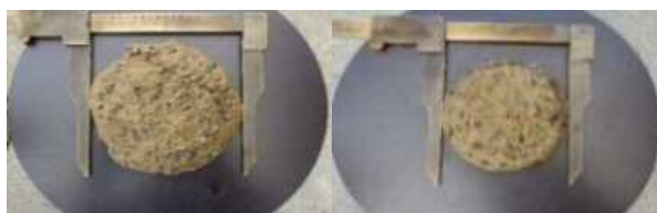
図-4 添加材試験（左が添加直後、右が7日後）
