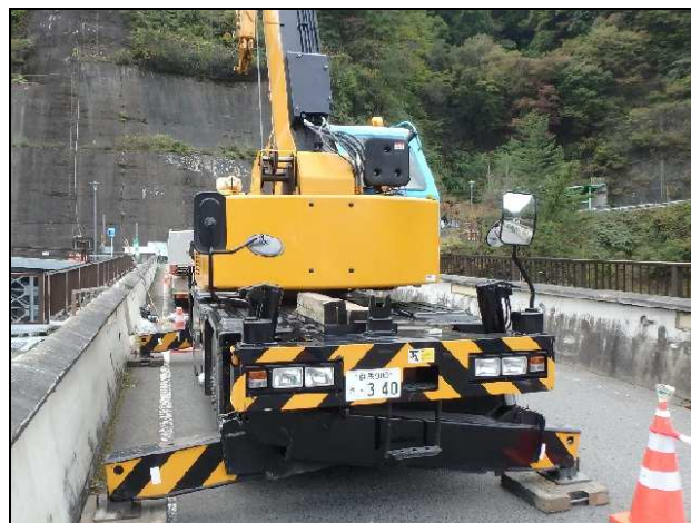
写真-3 12t小旋回型クレーン
