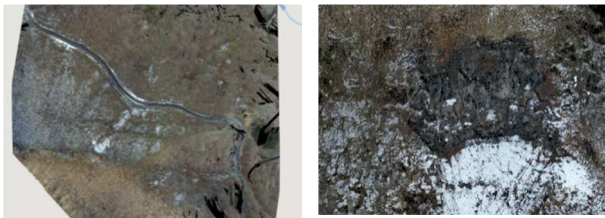
図-3 複数枚のUAV写真をオルソ写真化 図-4 落石箇所をSfM解析して3次元点群化
