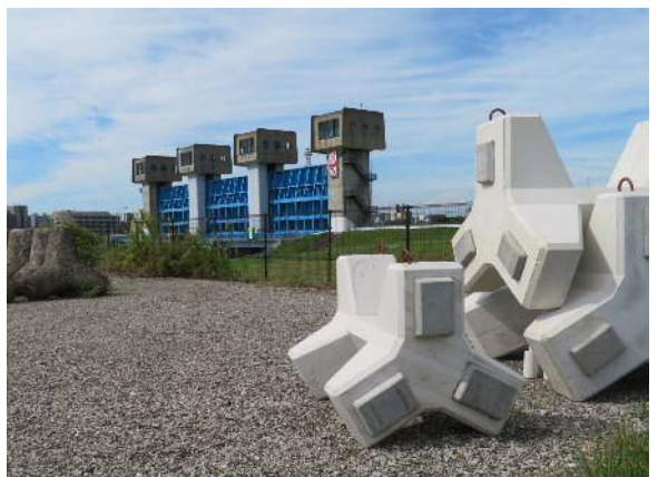
図-5 CO 2 吸収根固めブロックの暴露試験(2stage ヤード)
