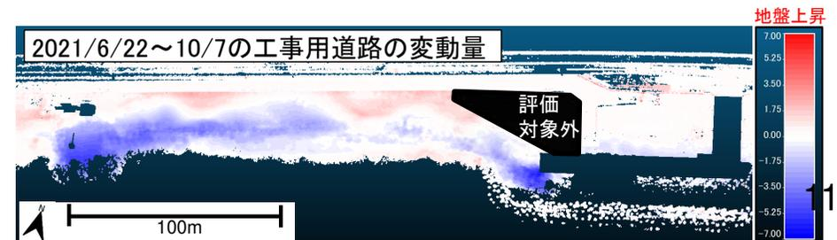
図-4 UAVの写真測量による地盤高と工事用道路の変動量
