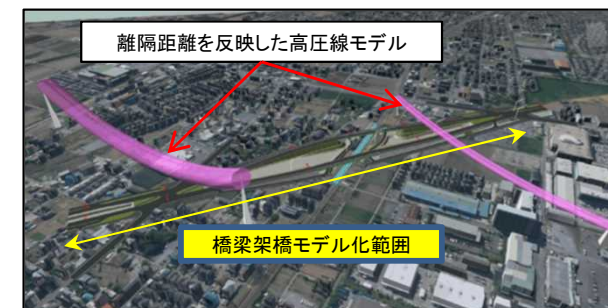
橋梁と架空線の離隔確認
