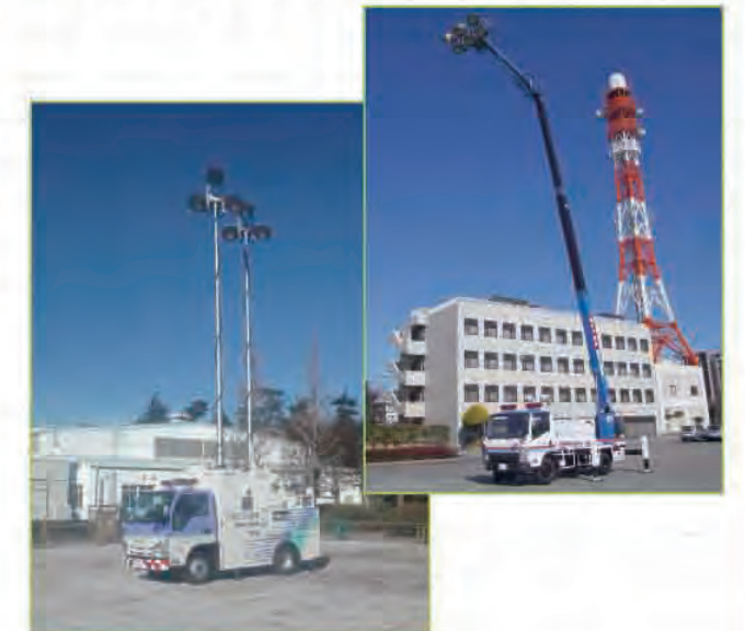
■ 照明車 夜間の災害復旧作業を行えるようにする車両です。
