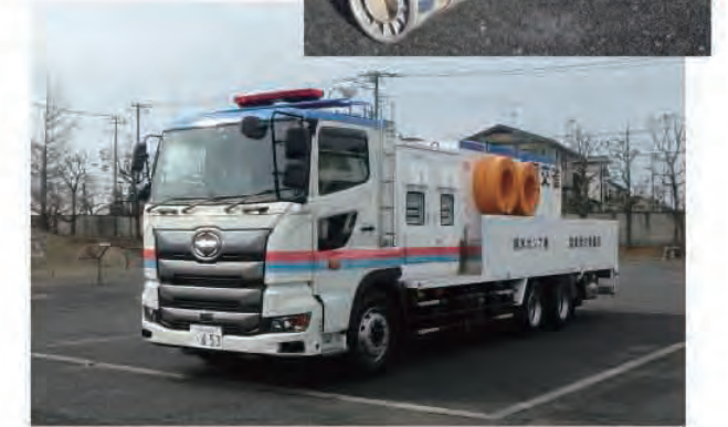
■ 排水ポンプ車 内水氾らんや洪水時に排水作業を行う車両です。
