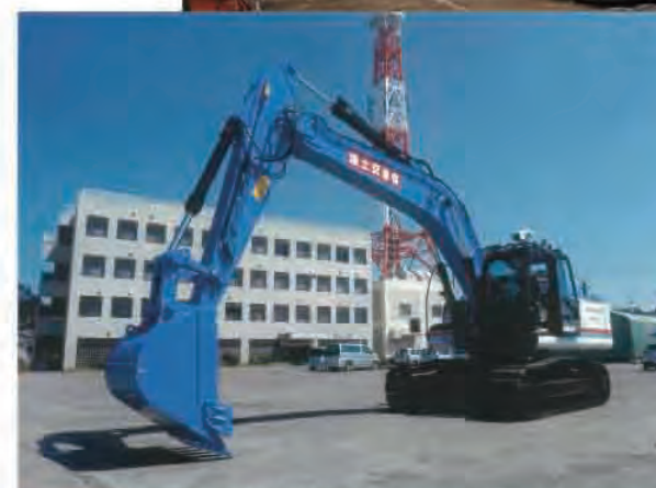
■ 遠隔操縦式 分解組立型 バックホウ 土砂崩れなどの二次災害発生の危険性がある現場で、安全に復旧作業を行う機械です。
