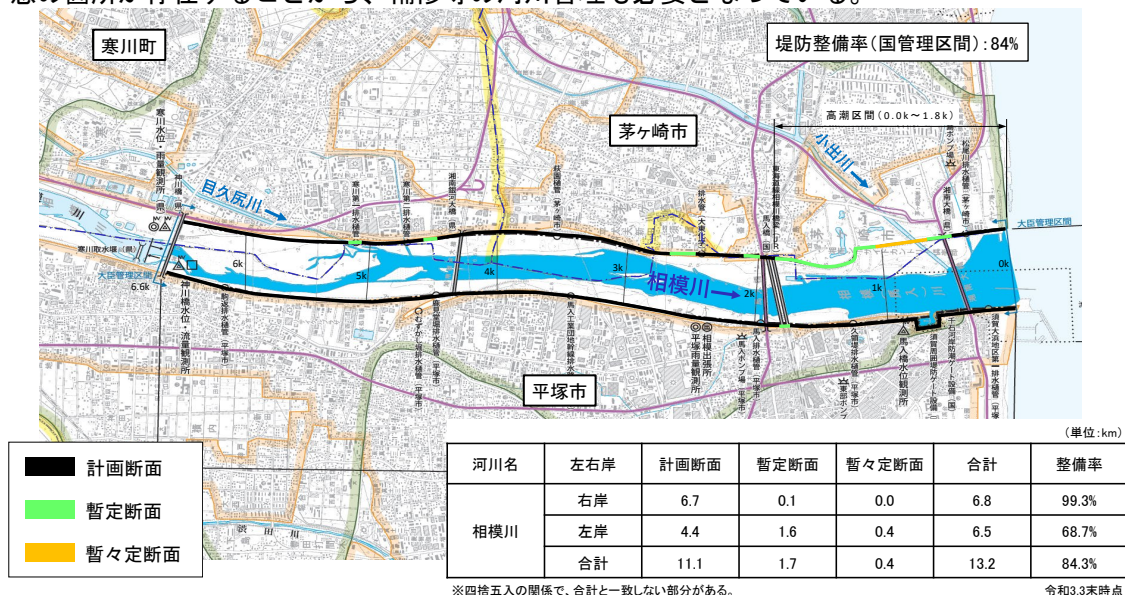
図 3-4 堤防整備状況（相模川：令和4年3月時点）
