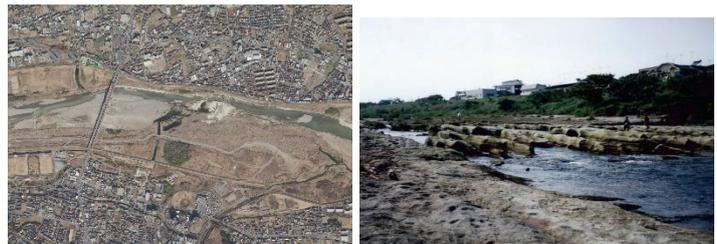
写真 1-2 土丹層が露出する多摩川中流部（42km 付近）
