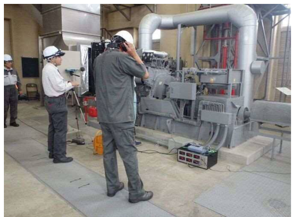
写真 6-3 排水機場（内視鏡調査・振動調査）
