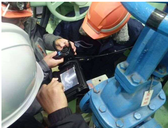
写真 6-3 排水機場（内視鏡調査・振動調査）
