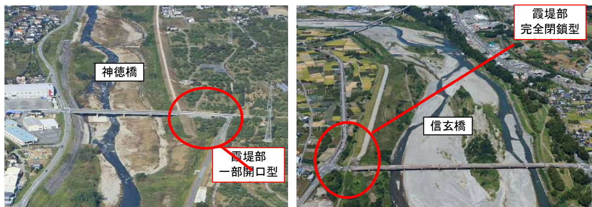
写真 3-4 霞堤が締め切られた事例
