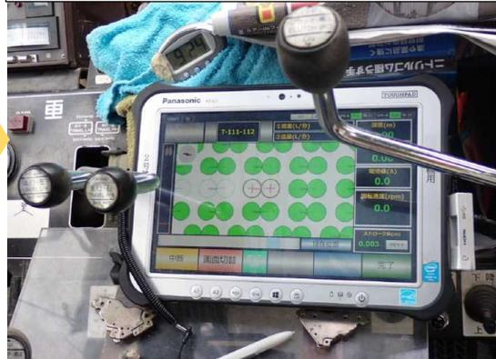
②深度管理(ICTモニターで施工時も確認) 施工機器システムにより施工深度を確認
