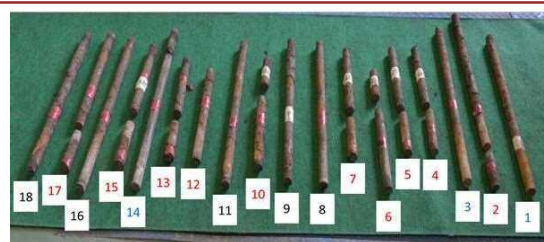
図 鉛直PC鋼棒サンプル採取状況
