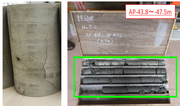
(写真-5) 改良体写真
