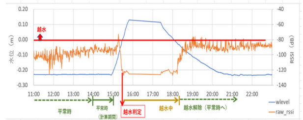
図-4 水位とセンサーの電波強度の計測結果（藤井川）
