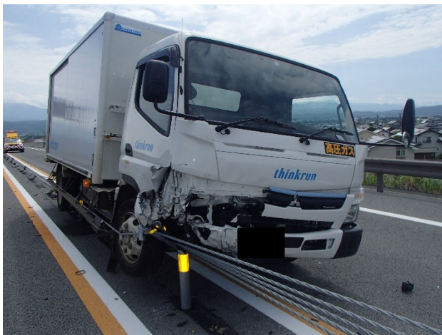
図-2 ワイヤーロープ式防護柵接触事故状況
