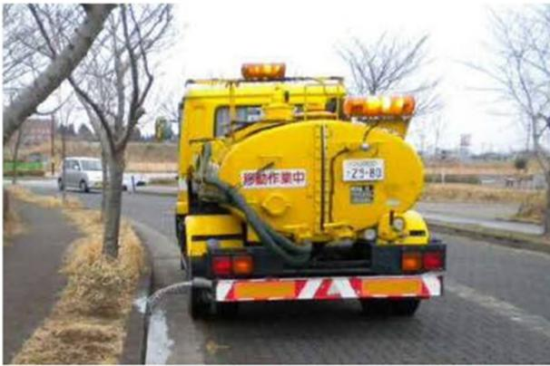
写真-3 路面清掃時の散水状況
