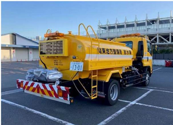
写真-4 散水車（給水装置付）の外観
