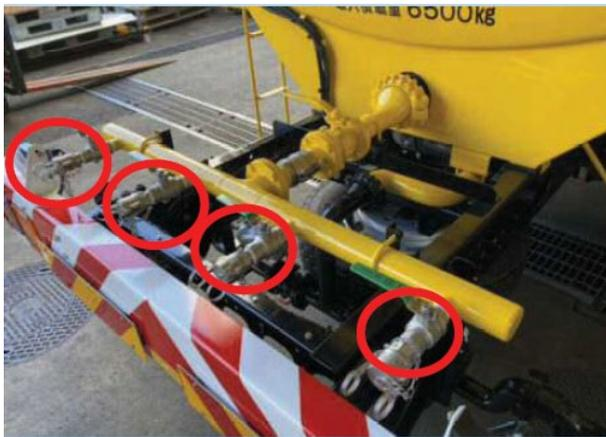
写真-5 散水車（給水装置付）の給水ノズル
