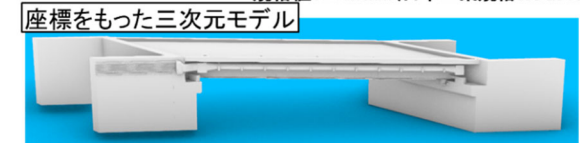
図-3 取得した三次元点群データ及び作成した三次元モデル
