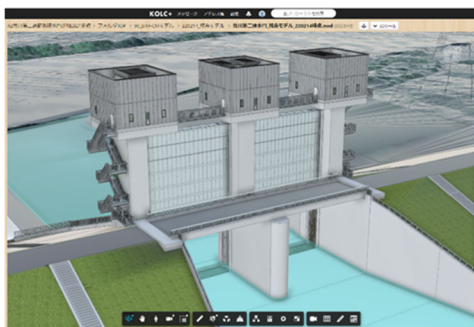
図-7 ASP (KOLC+) 上でBIM/CIMモデルを表示
