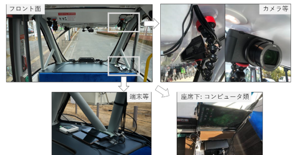
図-10 自動運転車両へのカメラ等設置の様子
