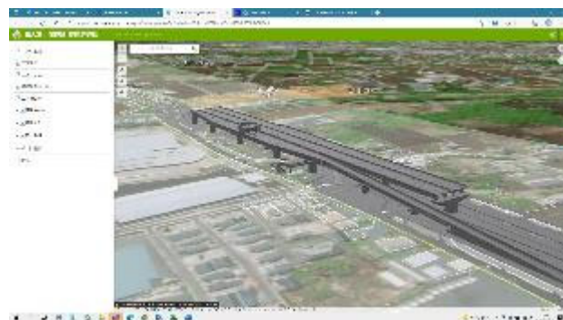
図-13 GISへのBIM/CIMデータの取込事例
