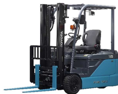
写真：燃料電池フォークリフト (神奈川県提供)
