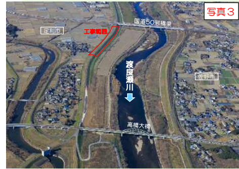
写真3 足利市 R2渡良瀬川右岸野田町地先築堤護岸工事 《堤防の高上げ・拡幅とともに護岸の整備を行います》
