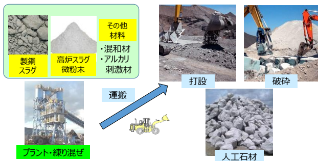
図-3 人工石材の製造工程
