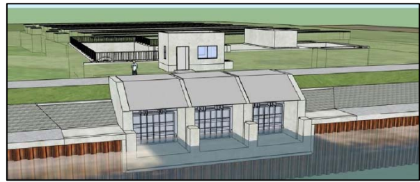
図-3 俯瞰図(油圧リンク式ゲート案)
