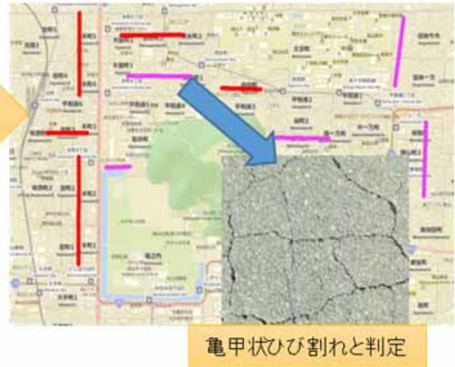
車を走らせるだけで、悪い舗装が自動的にマッピングされるシステム
