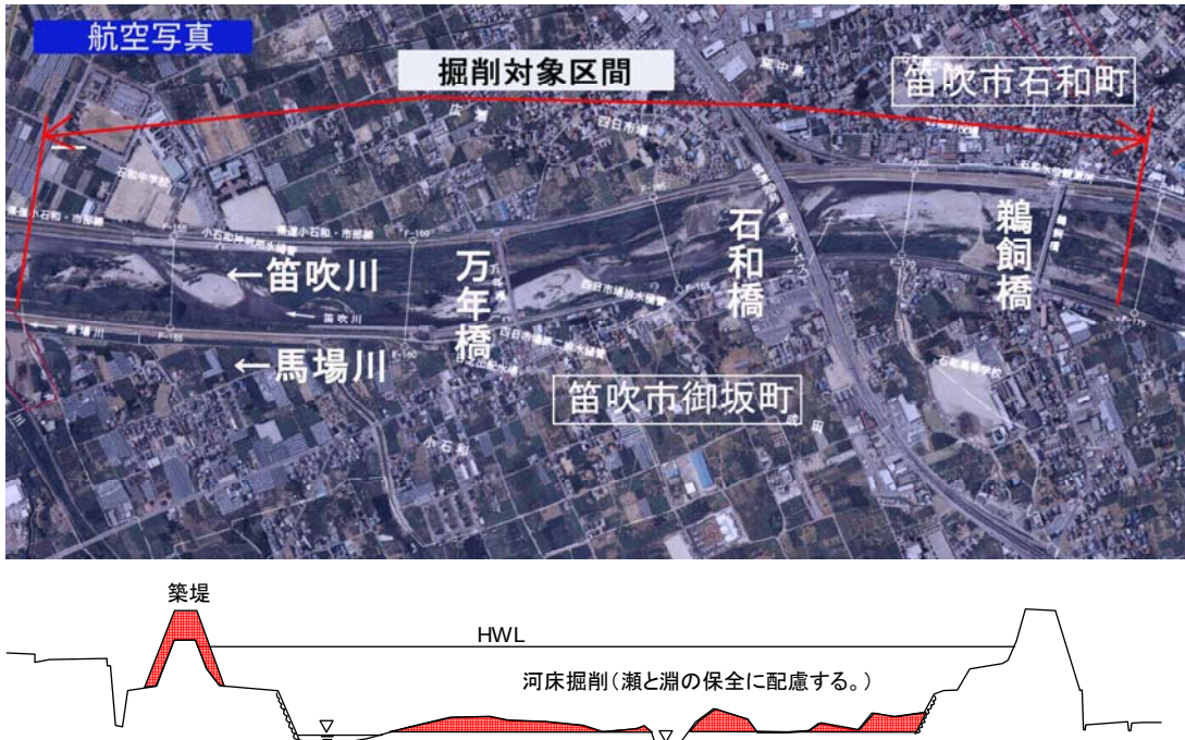
図-2.2.6 石和地区河床掘削
