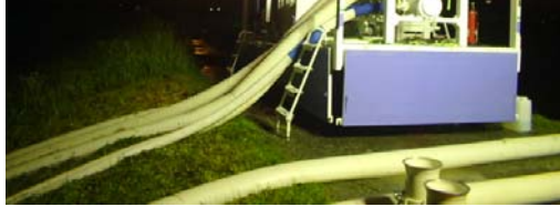
写真－2.3.5 排水ポンプ車
