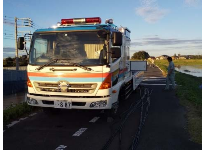
排水ポンプ車展開状況 10月13日午後
