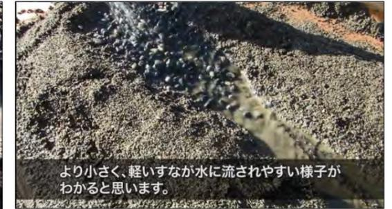
流水により堤防が決壊する仕組み
