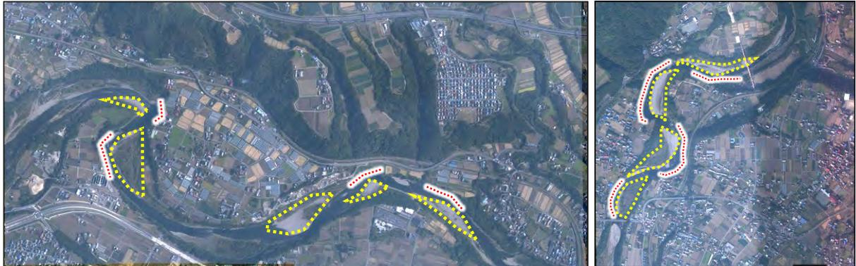
水衝部の侵食（赤破線）と水裏部の土砂堆積（黄色破線）（利根川：群馬県渋川市）
